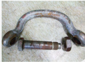
샤클 본체 파손
